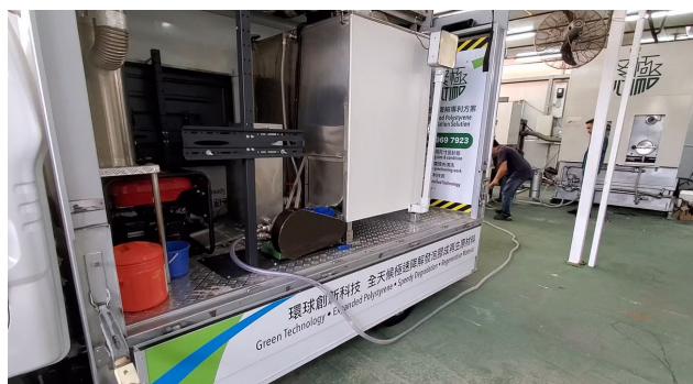
從發泡膠回收車抽取發泡膠混合物至淨化系統
