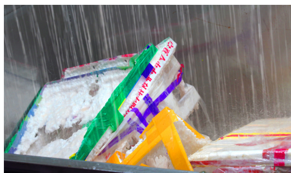
發泡膠透過終極溶液於降解缸內進行減容處理
