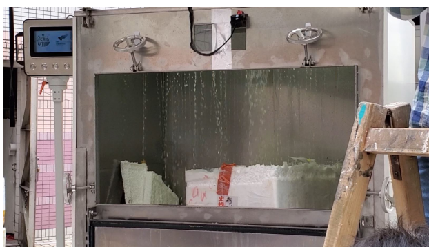
發泡膠透過終極溶液於降解缸內進行減容處理
