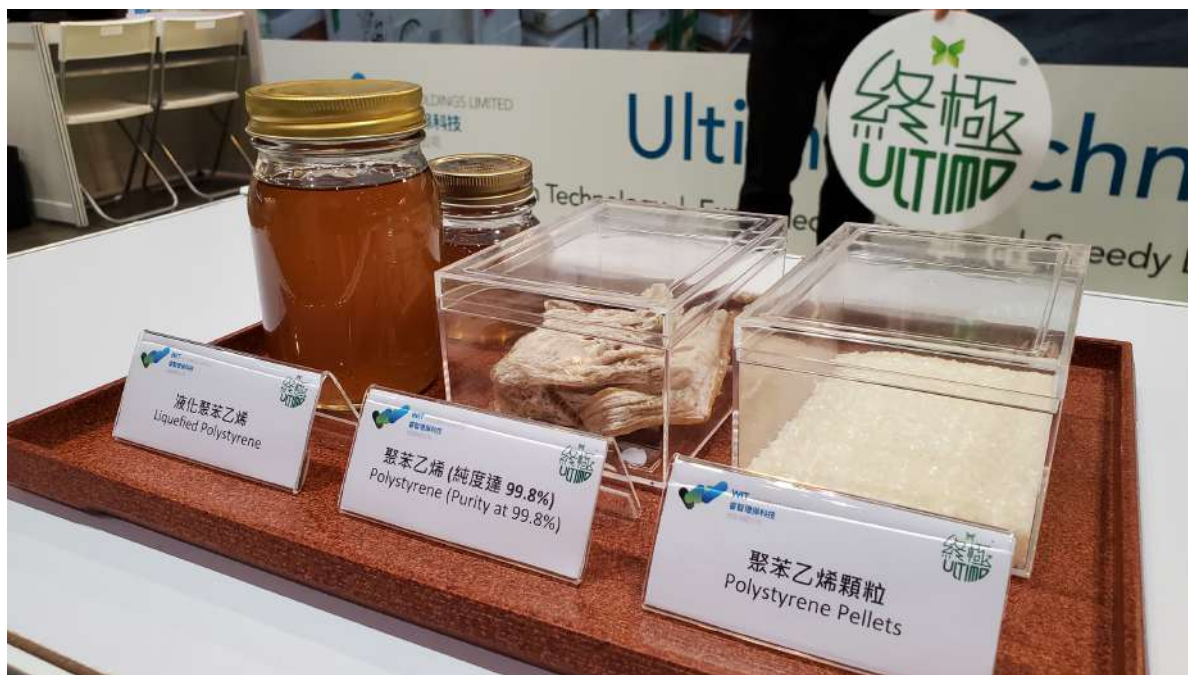
利用終極技術™ 從發泡膠廢物 (EPS) 再生出來的聚苯乙烯 (PS) 原材料
