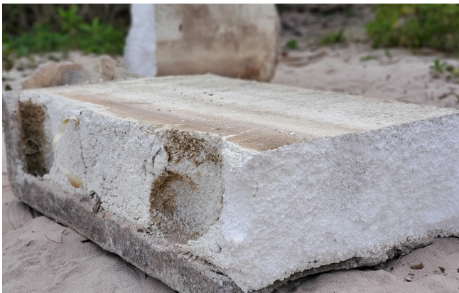
夾雜水泥的發泡膠廢料 (常見於建築業)
